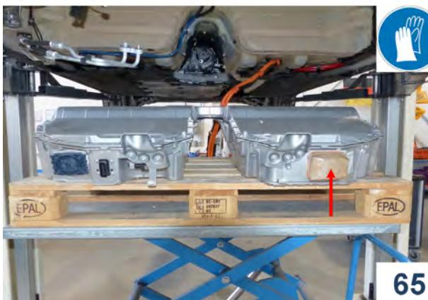
パレットには番線/針金/ワイヤー類などでボルト穴を使ってパレットとしっかり固定してください。
