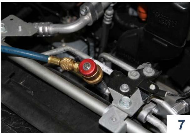
7. フロンガスが回収されていない場合、この時点で確実にフロン回収機でフロンガスを回収する。
