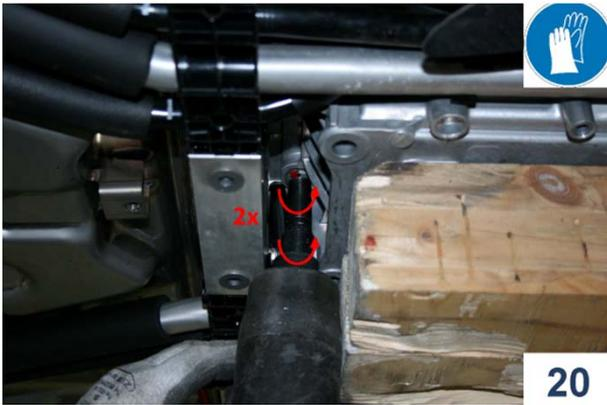
20. バッテリー後方の固定ボルトを外す。
