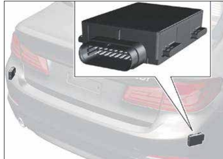
車両後方のセンサー位置
