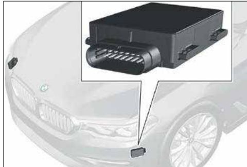
車両前方のセンサー位置
