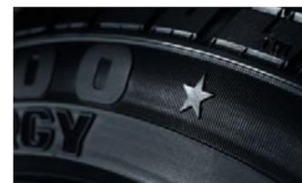
RSC(ランフラット・システム・コンポーネントを表します)の文字が表示されたランフラット・テクノロジーを採用したタイヤは耐久性の高いラバーでできた強化サイドウォールを持っていて、たとえ完全に空気が抜けてしまっても形状を保持して、時速約80km/hまでの速度で約80km(中程度の積載状態での可能な走行距離)\*までの走行が可能です。
