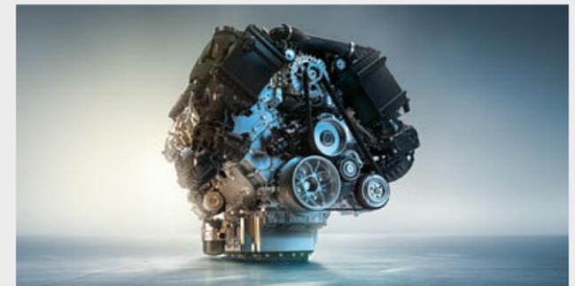
鍛えぬかれた、V型8気筒 M ツインパワー・ターボ・ガソリン・エンジン。2つのターボチャージャーと、インターク・バルブのリフト量を無段階に可変制御するバルブトロニック、高精度ダイレクト・インジェクション・システムの組み合わせにより、最高出力は390kW(530ps)、最大トルクは750Nmを発揮します。ターボチャージャーは、シリンダー・バンクの間へコンパクトに収められています。
