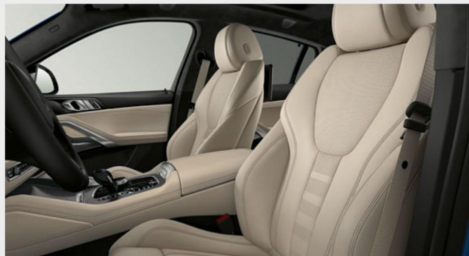
スポーティで快適なドライブを。個別に調整可能な標準装備のスポーツ・シート（運転席&助手席）は、バックレストの幅や角度、シートの角度を含む多くの電動調節機能を特徴としています。高さのあるシート・サイド・クッションとバックレスト・サイド・クッション、そして調整可能なサイ・サポートは、タイトなコーナリング時に卓越したエルゴノミクスとより確実なサイ・サポートを提供します。
